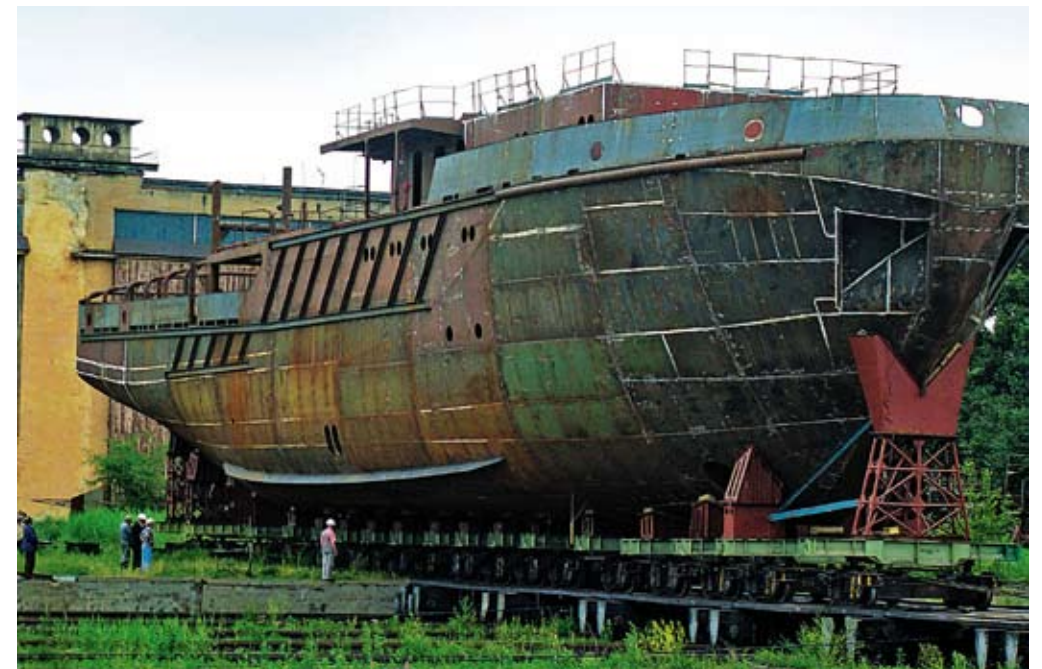
Морской буксир. Перемещение судна на достройку в эллинг. Пр. 22030
