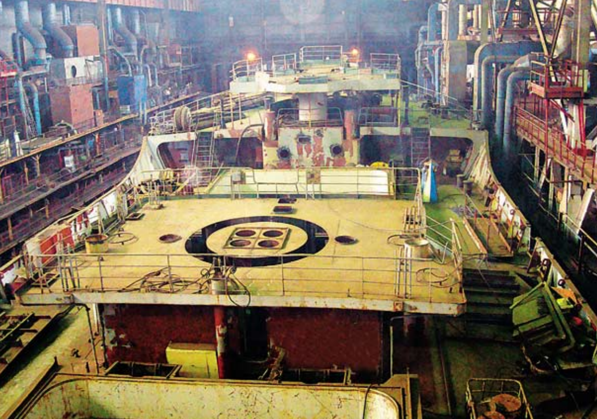
Большой морской сухогрузный транспорт «Яуза». В доке. Вид на фундаменты грузовых стрел. Пр. 550
