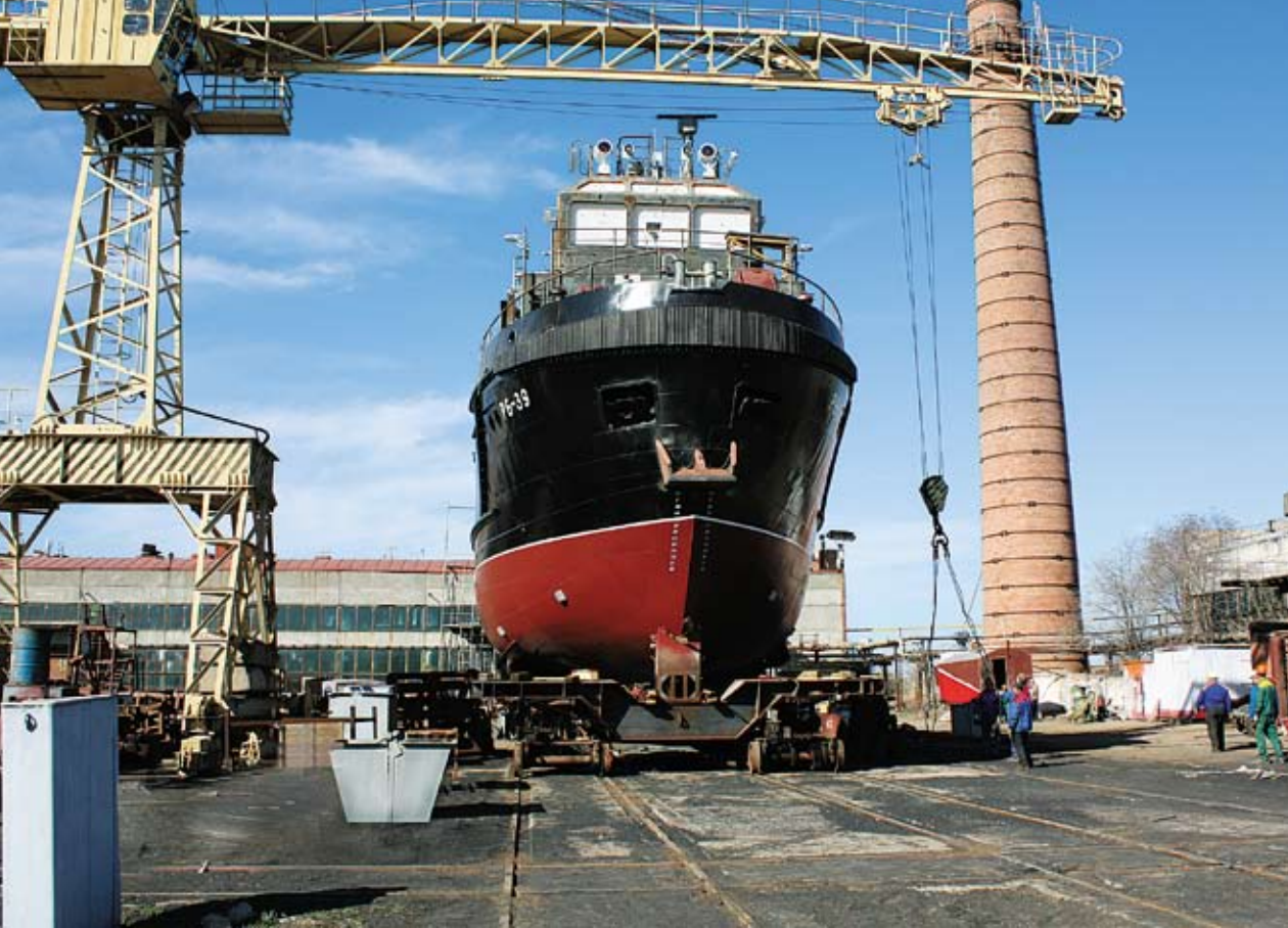
Рейдовый буксир. Передвижка судна из эллинга для спуска на воду. Пр. 7056
