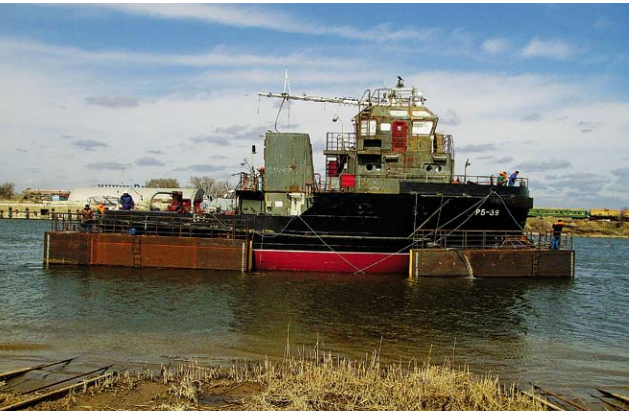
Рейдовый буксир. Понтонирование судна для вывода с акватории завода-строителя. Пр. 7056
