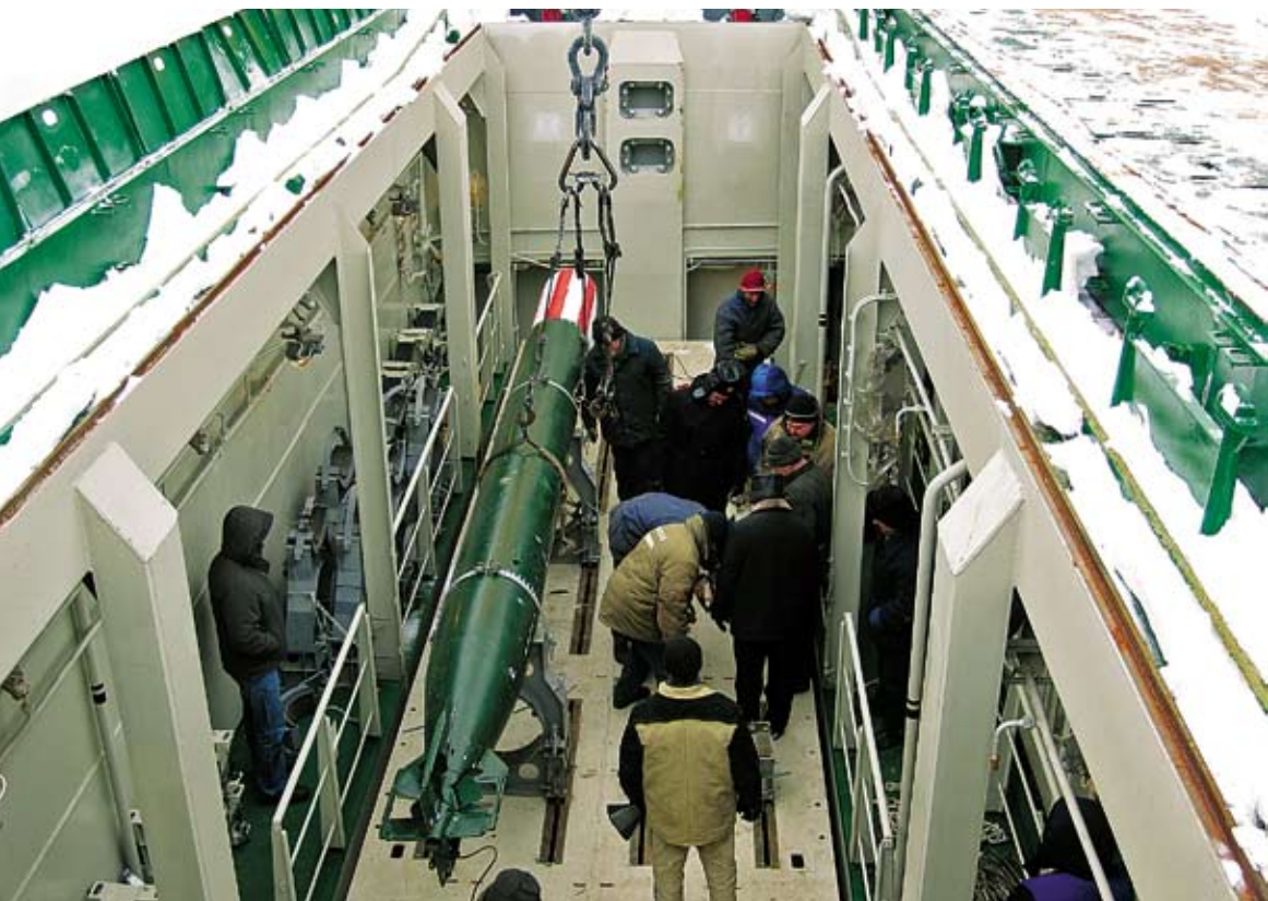
Крановое судно-погрузчик. Испытания фундаментов под макеты изделий. Пр. 20360
