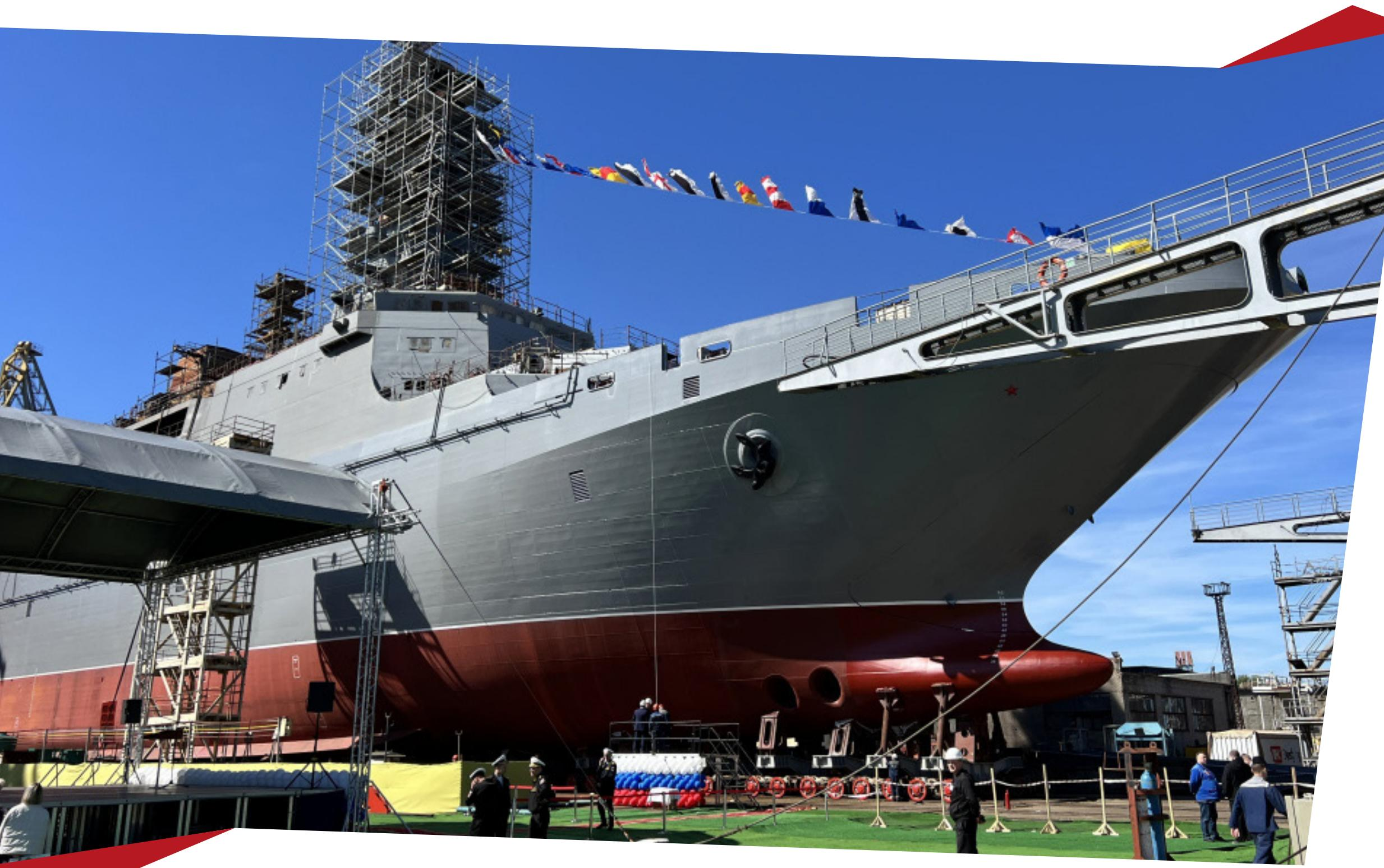
Корабли проекта 11711 строятся по модернизированному Невским проектно-конструкторским бюро ОСК проекту по заказу Министерства обороны России. Модернизированный проект отличается архитектурой и имеет, в частности, обширную полетную палубу для вертолетов в кормовой части.
